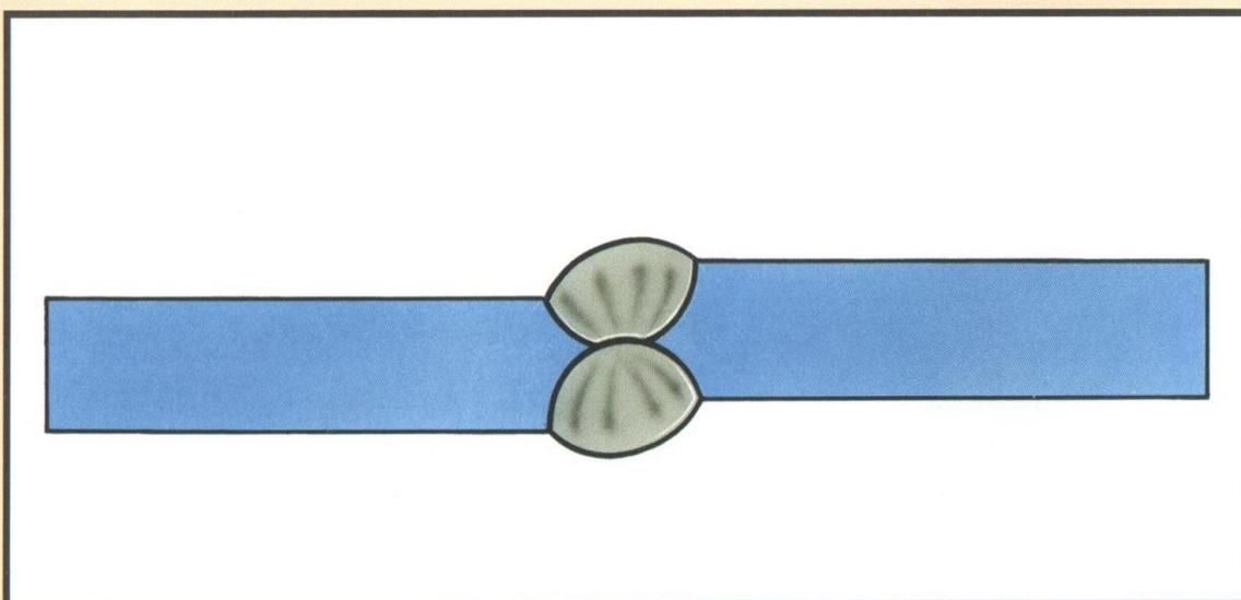
**Внешние признаки:** расположение двух свариваемых деталей не в одной плоскости. Дефект виден невооруженным глазом. Размер смещения определяют при измерительном контроле.
