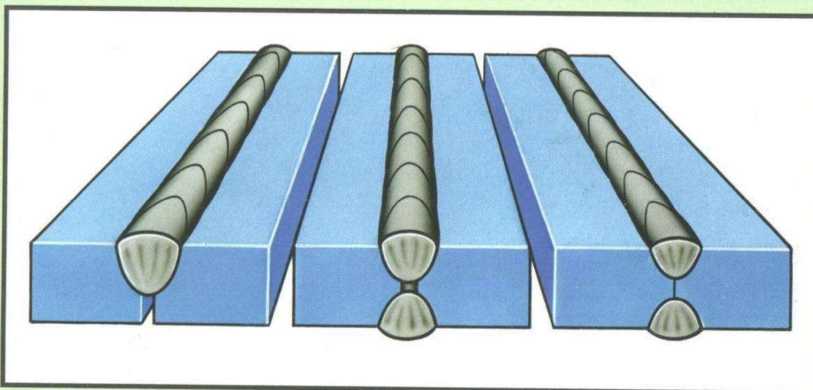
**Внешние признаки:** отсутствуют, так как дефект находится внутри сварного шва. Обнаруживают методом неразрушающего контроля.
