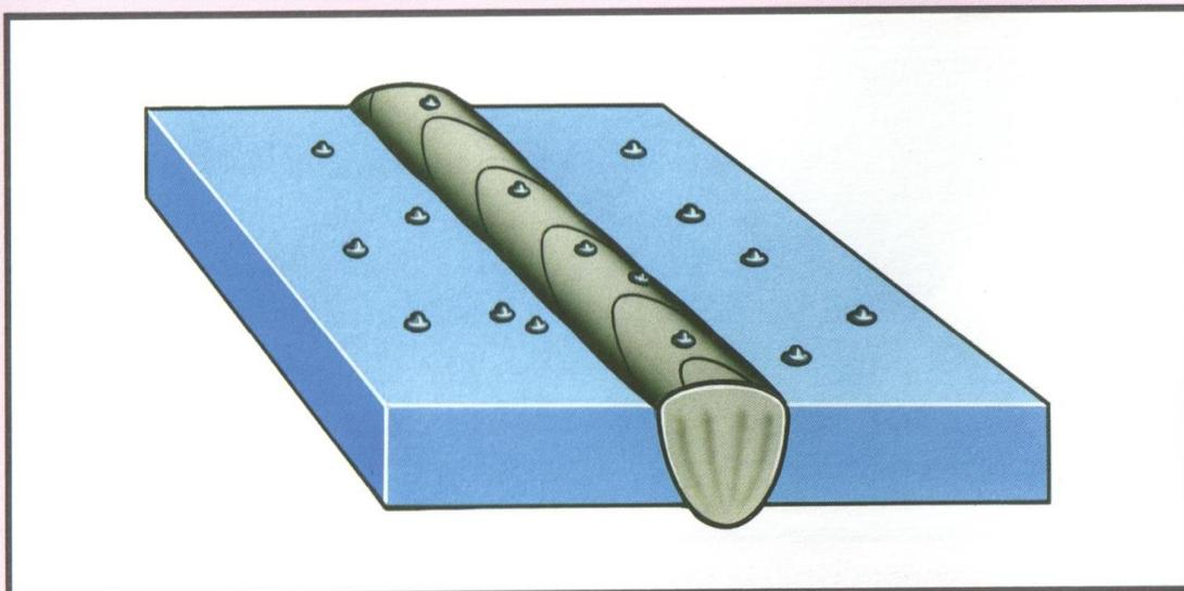
**Внешние признаки:** мелкие капли электродного металла, осевшие на лицевую сторону сварного соединения и плотно сцепившиеся с поверхностью основного металла. Дефект виден невооруженным глазом при визуальном контроле.
