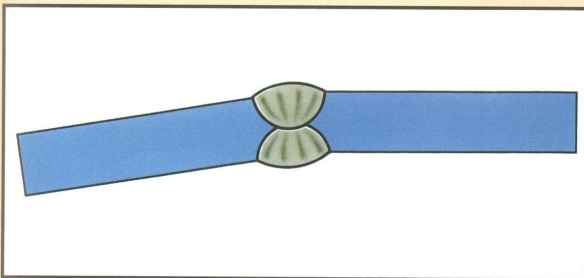
**Внешние признаки:** расположение двух сваренных деталей под некоторым углом относительно друг друга. Дефект виден невооруженным глазом. Размер смещения определяют при измерительном контроле.
