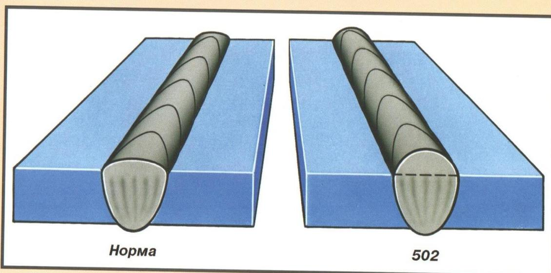
**Внешние признаки:** выпуклость сварного шва превышает 2-3 мм над уровнем основного металла.
