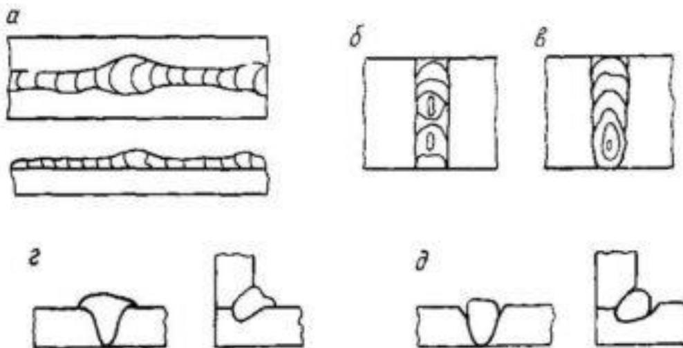
**Рис. 1.3. Внешние дефекты сварных швов:**
