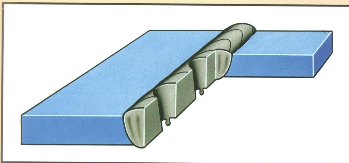
**Внешние признаки:** сквозные отверстия или полости, образованные вследствие расплава сварочной ванны.
