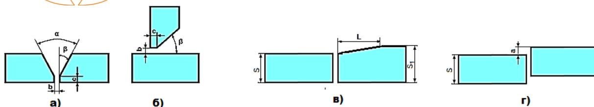
$\alpha$  - угол разделки кромок (60-90)<sup>0</sup>
