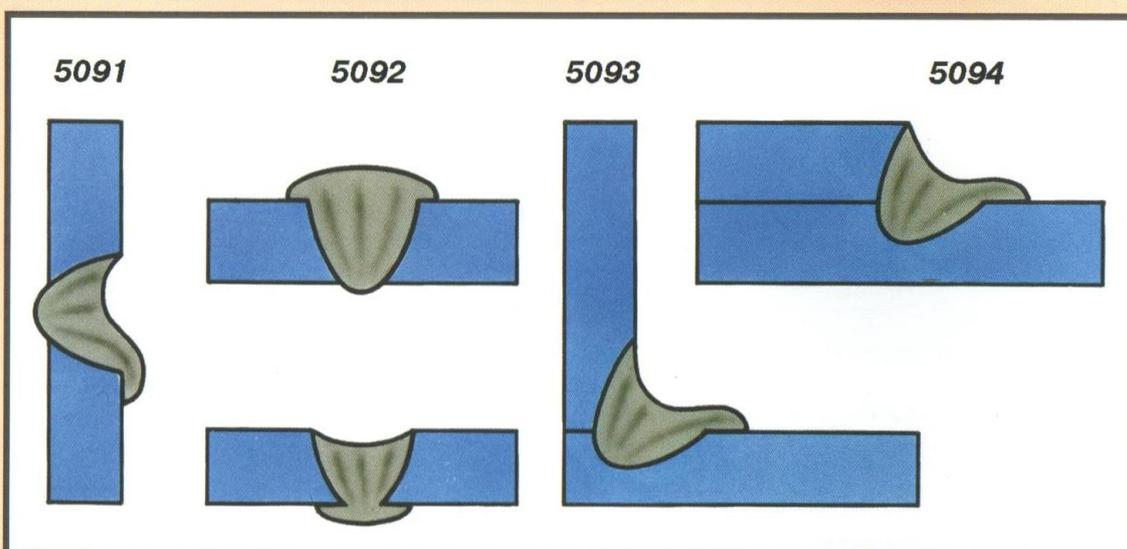
**Внешние признаки:** расплавленный металл сварочной ванны натек на одну из кромок без сплавления с ней, что привело к дефекту формообразования.
