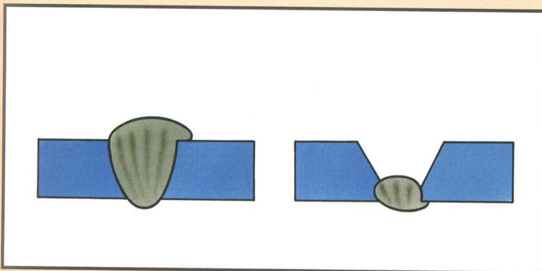
**Внешние признаки:** избыток металла шва по его краю. Дефект виден невооруженным глазом при визуальном контроле.
