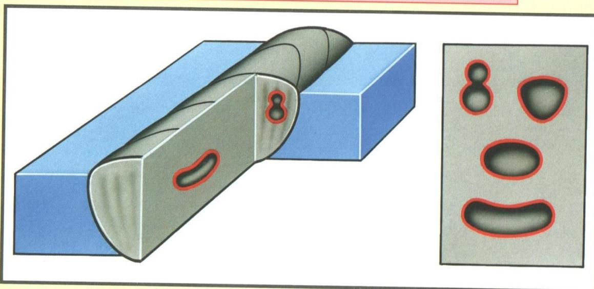
**Внешние признаки:** отсутствуют, так как дефект находится внутри сварного шва. Обнаруживают методом неразрушающего контроля.
