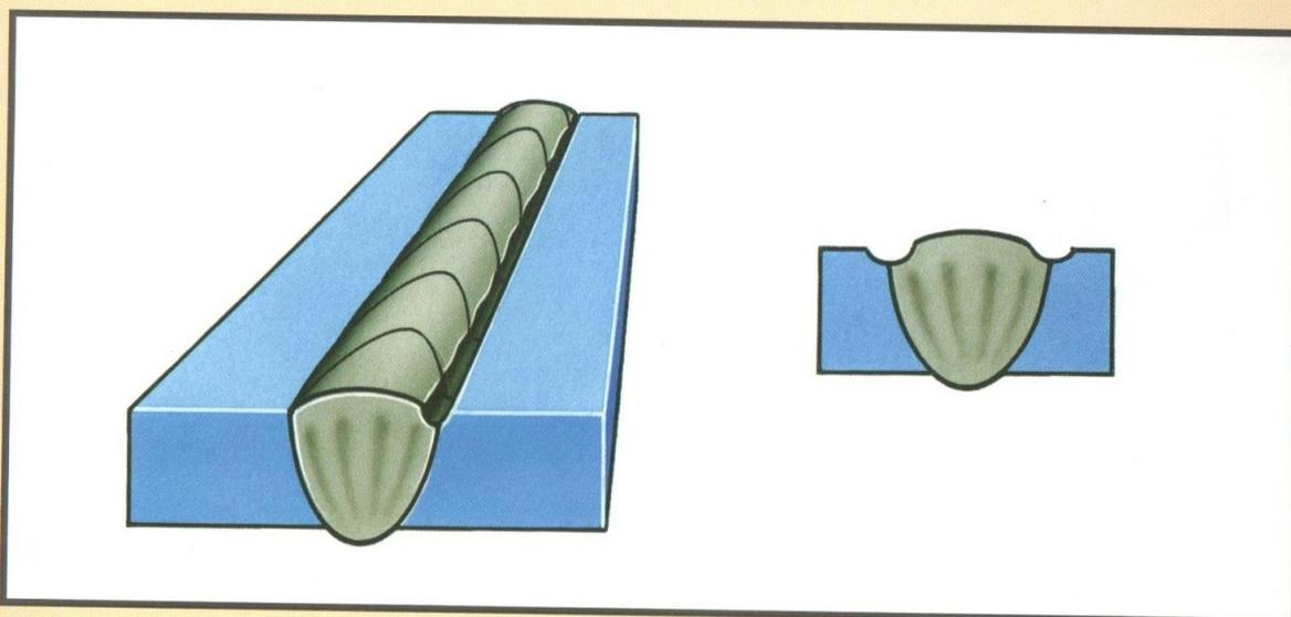
**Внешние признаки:** углубление на протяжении всего шва по линии сплавления металла шва с основным металлом.
